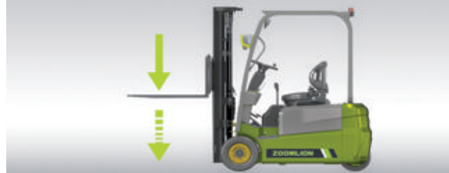
Asansör akıllı tampon sistemi sayesinde çatallar yere düştüğünde, aracın çarpmasını ve malların hasar görmesini önlemek için açılma hızı otomatik olarak düşürülür.
