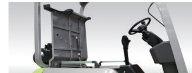
Akü kapağı hidrolik itici desteğiyle tamamen açılır ve akünün bakımı kolaylaşır.
