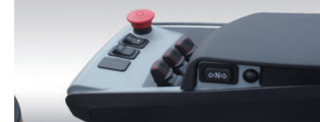
İsteğe bağlı parmak ucu kontrol sistemi öne,arkaya,yukarı,aşağı ve yana doğru gitmek için ayarlanmış kontrol düğmeleri mevcuttur.Acil durum anahtarı, bir korna aydınlatma kontrolü ve diğer kontrol düğmeleri bir aradadır.
