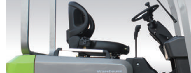
Sürücünün yorgunluğunu azaltabilen ve iş verimliliğini artıran süspansiyon sönümlenme işlevine sahip gelişmiş süspansiyonlu koltuk mevcuttur.
